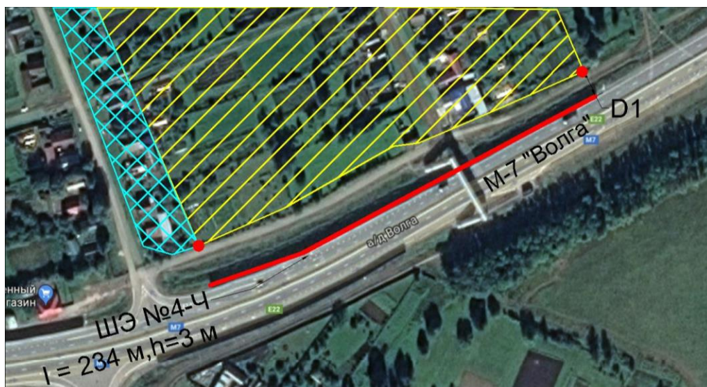
Рисунок 4.2 – Схема расположения ШЭ и прилегающей селитебной территории (ЖЗ по левую сторону ШЭ осталась незащищенной)
